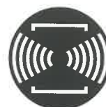
非常放送設備 Emergency Announcement System
